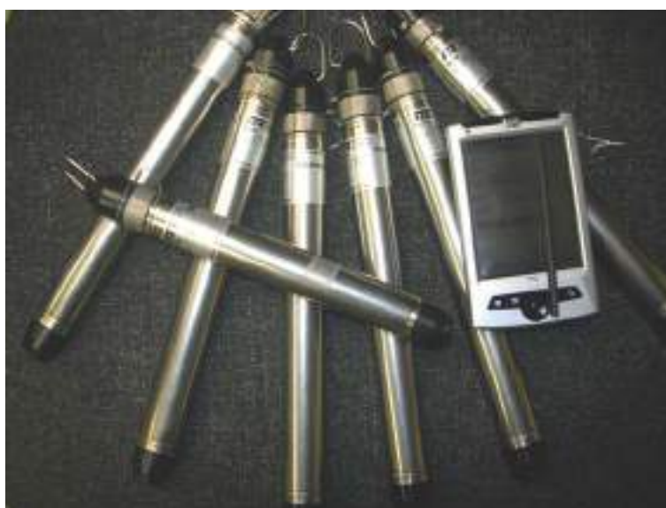
Figura 36 - Datalogger DL/N 70 prodotti da STS
